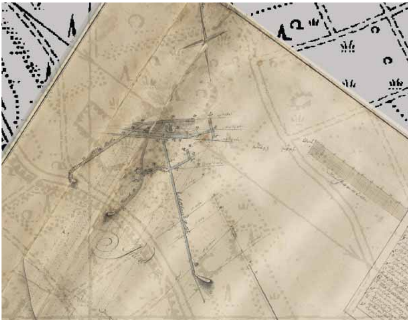
Fig. 6: Transparente Überlagerung eines georeferenzierten Rissblattes über eine topographische Karte. Der nicht exakt nach Norden ausgerichtete Nordpfeil weist auf die geometrischen Ungenauigkeiten der topographischen Aufnahme des Rissblattes aus dem Jahr 1774 hin. Zwei Stollenmünder liegen unterhalb eines heutigen Straßenkörpers und könnten eine Gefährdung darstellen
